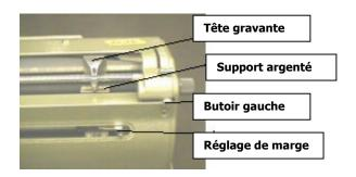
Légèrement au-dessous du butoir gauche il y a un dispositif de **réglage de marge** se composant d'une barre au-dessus d'une boule. La marge correspondante est réglée au bord droit de la Perkins.
