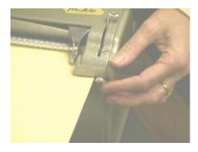
Insérer l'extrémité de la feuille (largeur) entre la tête gravante et son support argenté. Glisser la feuille jusqu'à ce que l'extrémité soit située entre le rouleau noir et le rouleau argenté. Positionner le papier vers l'extrême gauche. Abaisser les leviers de dégagement. Rouler le papier dans la Perkins en tournant les deux boutons d'alimentation jusqu'au point de blocage. Appuyer une fois sur le retour chariot.
